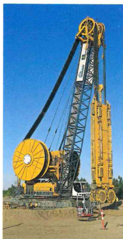
REKORD II In Kanada erreichte eine BC-50-Fräse von Bauer über 250 Meter Tiefe.
